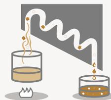
LE GOÛT DU PRODUIT EST PRÉSERVÉ PAR UNE CONCENTRATION DOUCE JUSQU'À 72° BRIX. L'EAU S'ÉVAPORE. LES ARÔMES VOLATILES ET FLORAUX SONT RÉCUPÉRÉS ET RÉINJECTÉS DANS LE CONCENTRÉ FINAL.
